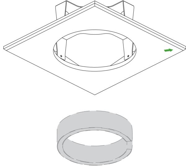
Unterkonstruktion erstellen und Einbauplatte bündig montieren!
