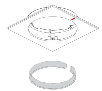
Vor der Montage die Ausrichtung der Leuchte mit Hilfe der Markierung bestimmen
