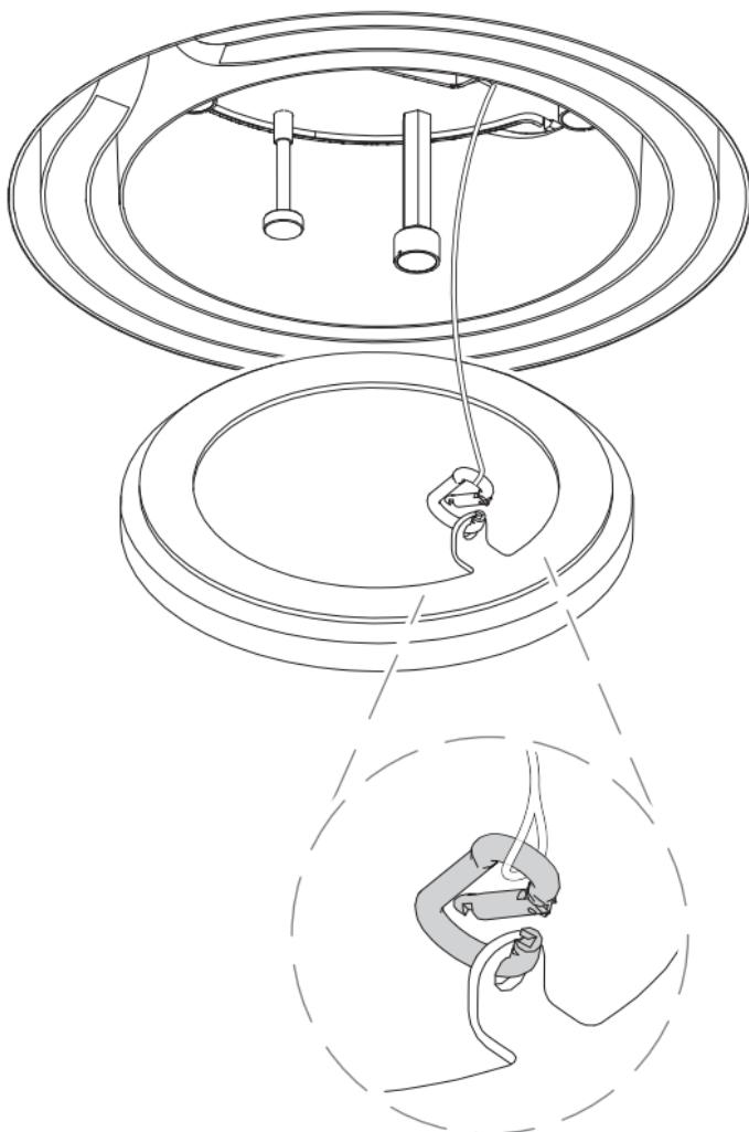
Leuchte von Magneten lösen, nicht entnehmen!
