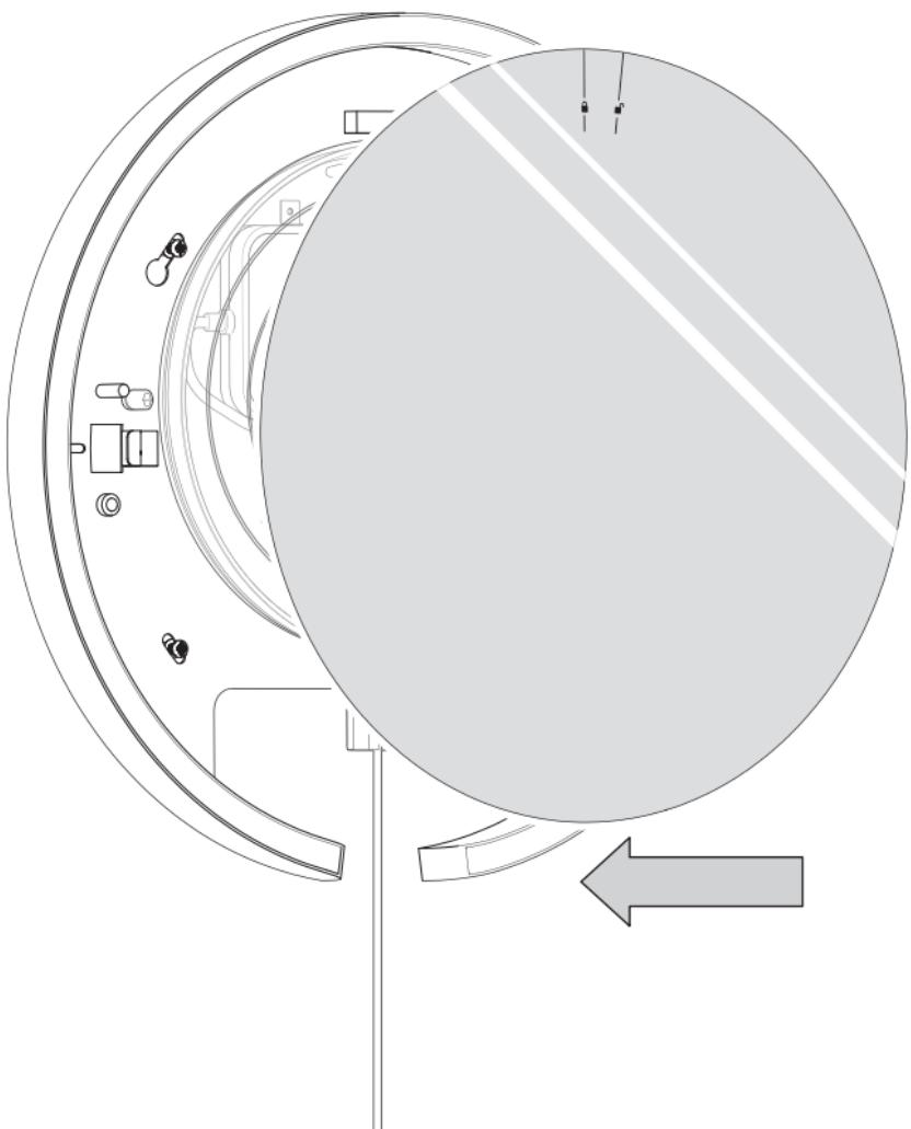
Zum Fixieren nach rechts drehen und Schutzfolie abziehen
