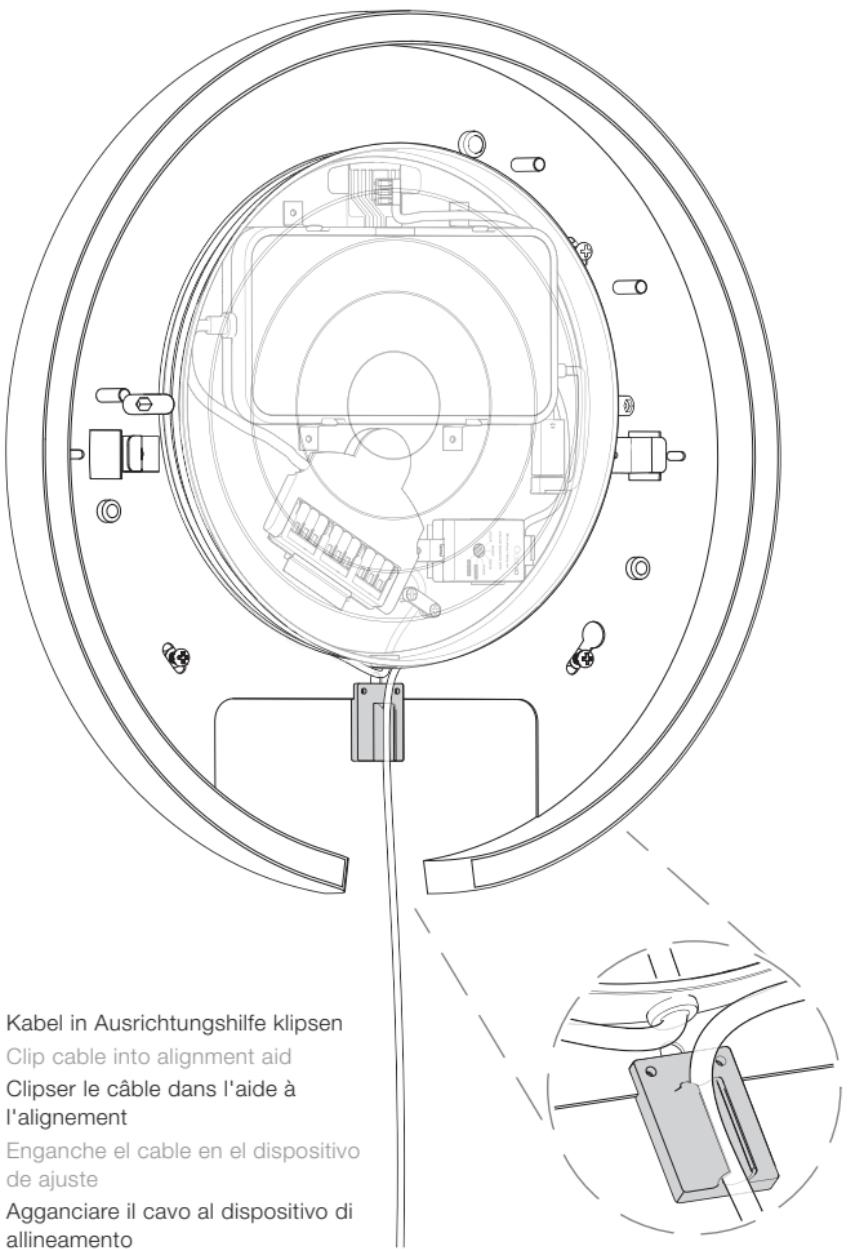
Kabel in Ausrichtungshilfe klippen
