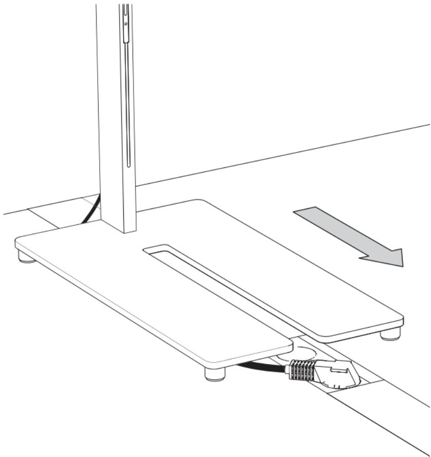
Die höheren pads eignen sich besonders um Steckdosenleisten die im Tisch integriert sind unter der base verschwinden zu lassen.
