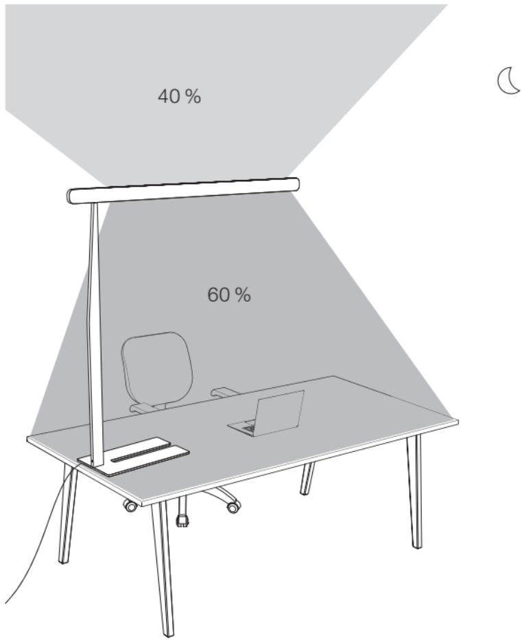
Die Leuchte startet mit den gespeicherten Werten (up 30 % down 50 %), gleicht sie mit der Umgebung ab und passt sie erneut an (up 40 % down 60 %)
