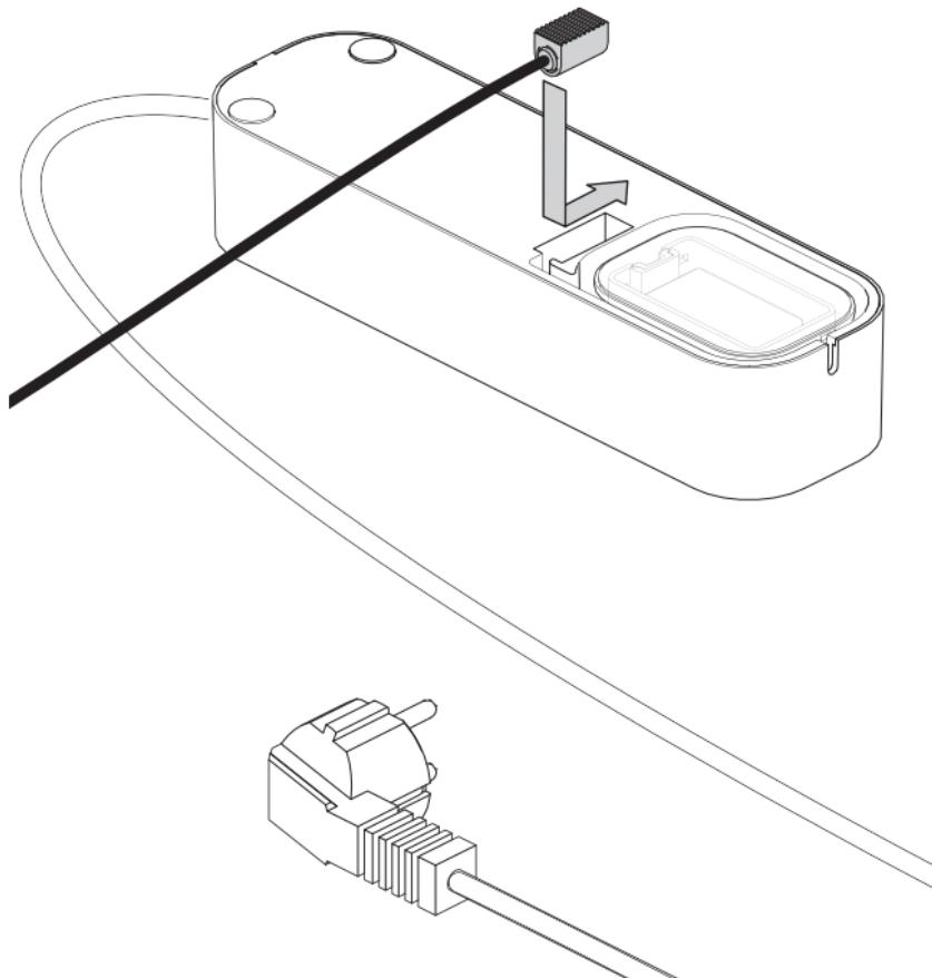
Kabel, bis die gewünschte Länge erreicht ist, aufwickeln.
