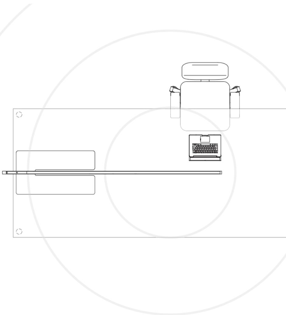
Der Sensor ermöglicht das Schalten durch Ab- bzw. Anwesenheit im Raum, er reagiert auf die Bewegung bzw. das Wärmeprofil. Die Nachlaufzeit – also die Zeit wie lange die Leuchte ohne Bewegung eingeschaltet bleibt – ist einstellbar via Occhio air App → **Seite 36**
