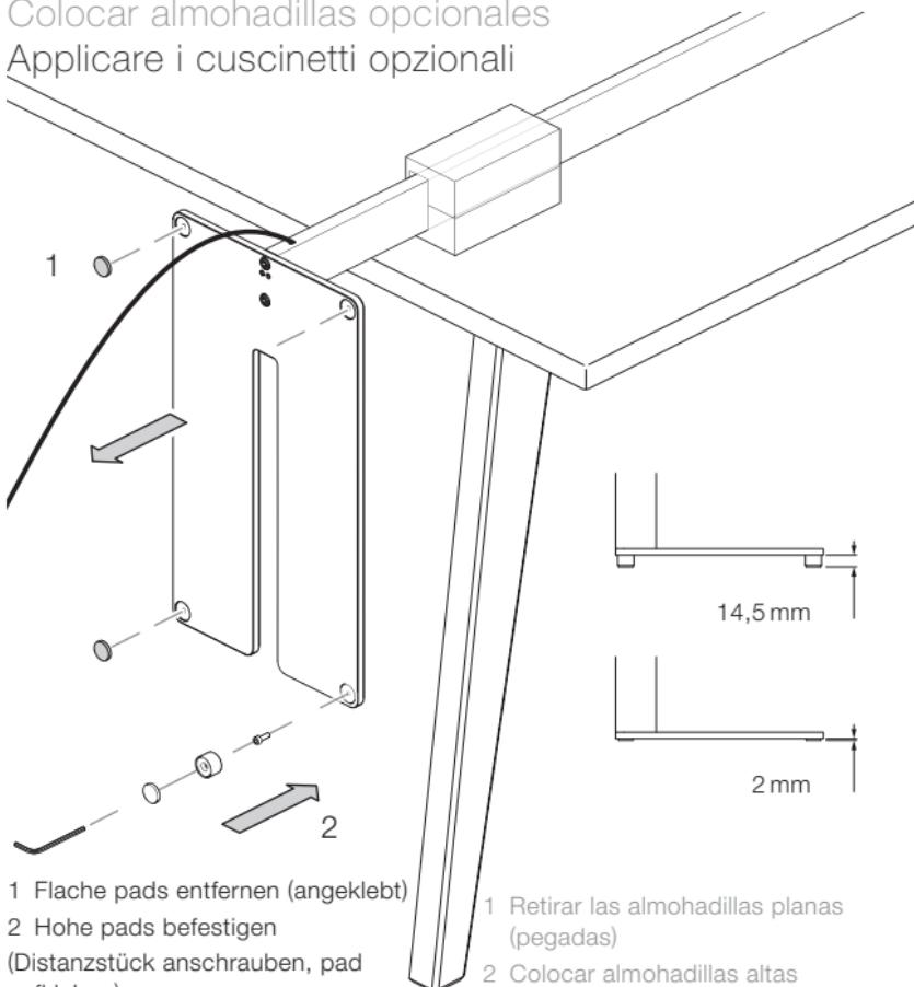
1 Flache pads entfernen (angeklebt)
