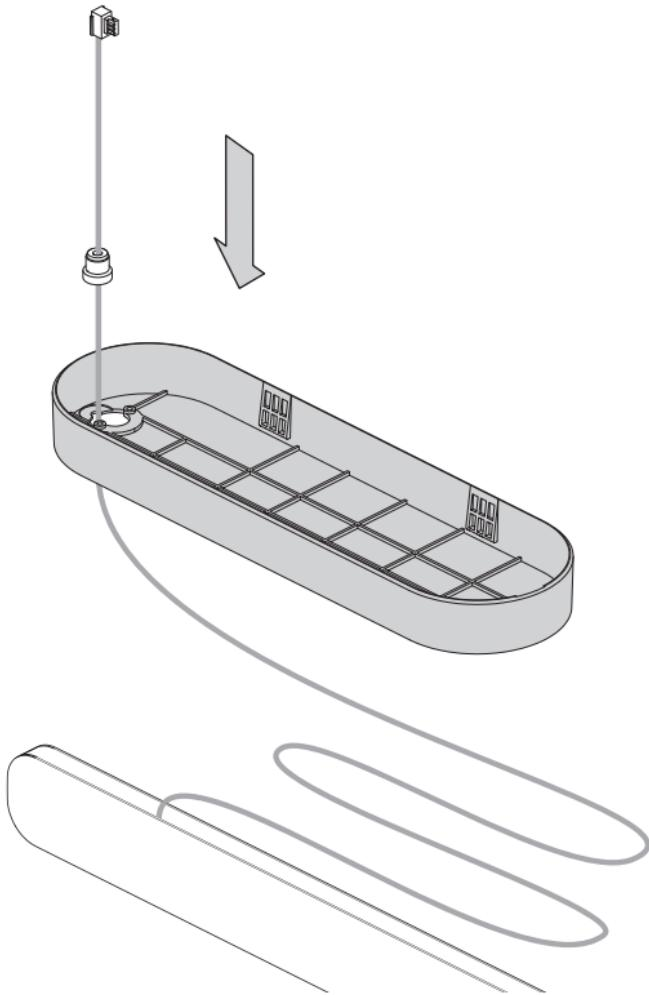
Kabel durch das cover und die Seilabhangung führen
