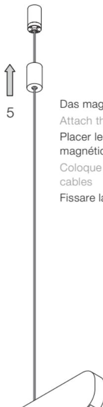
Das magnetisch gehaltene cover der Seilabhängung aufsetzen
