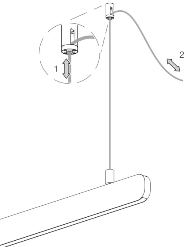
Kabel aufwickeln und Steckverbindung herstellen
