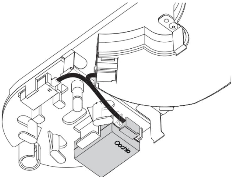
Das Kabel durch die Intarsienöffnung des cover führen
