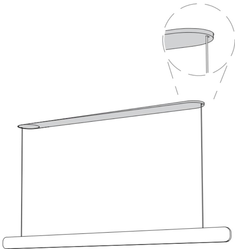
Leuchte leicht anheben und mit den VerstelleSchrauben ausrichten
