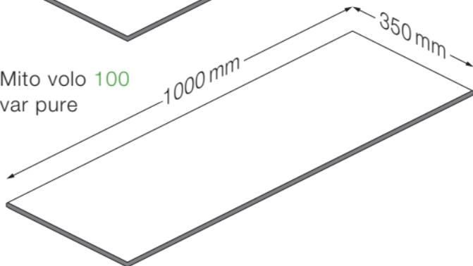
Unterkonstruktion erstellen (schräge Decke ausgleichen) und Einbauplatte bündig in der Öffnung montieren!
