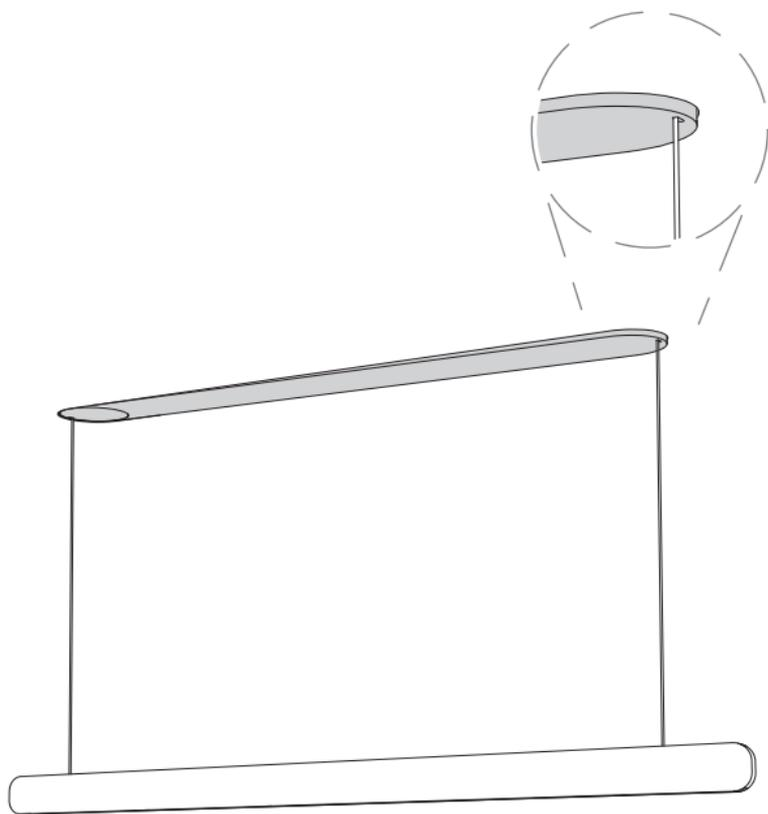
Leuchte leicht anheben und mit den Verstellerschrauben ausrichten
