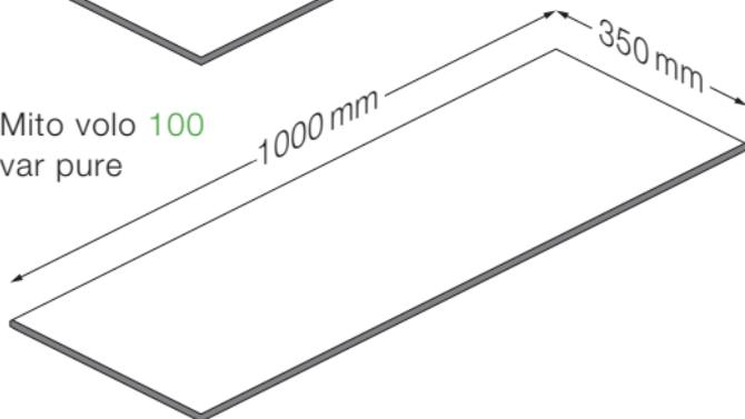
Unterkonstruktion erstellen (schräge Decke ausgleichen) und Einbauplatte bündig in der Öffnung montieren!
