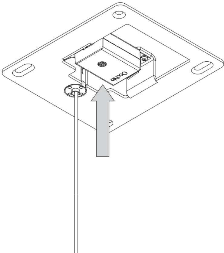
Die magnetisch gehaltenen Abdeckungen der Seilabhängungen aufsetzen.
