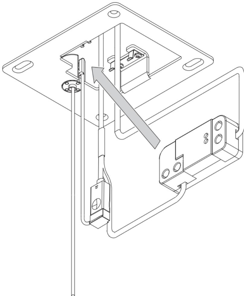
Die magnetisch gehaltenen Abdeckungen der Seilabhängungen aufsetzen.
