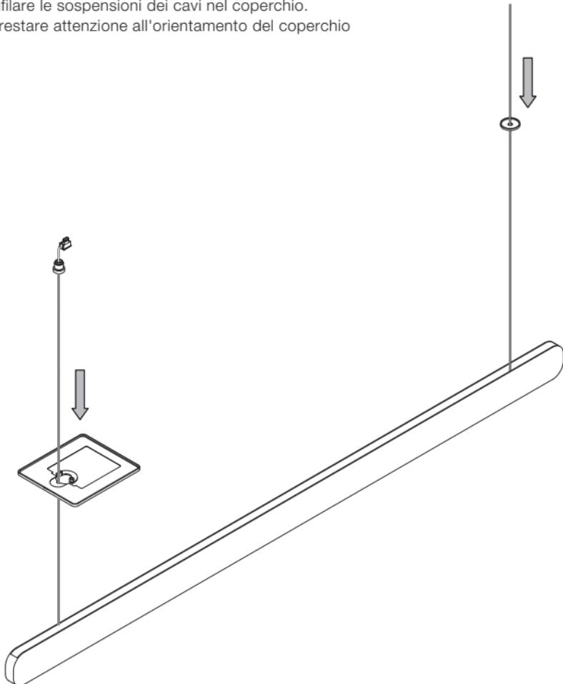
1. Seilabhängung in Kabeldurchführung einfädeln. 2. Kabelführung in die Montageplatte einschrauben. Hierzu Occhio Tool benutzen.
