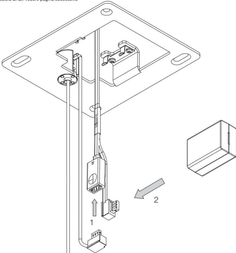
Kabel und Steckerverbindungen in der Hohlraumdecke verstauen.
