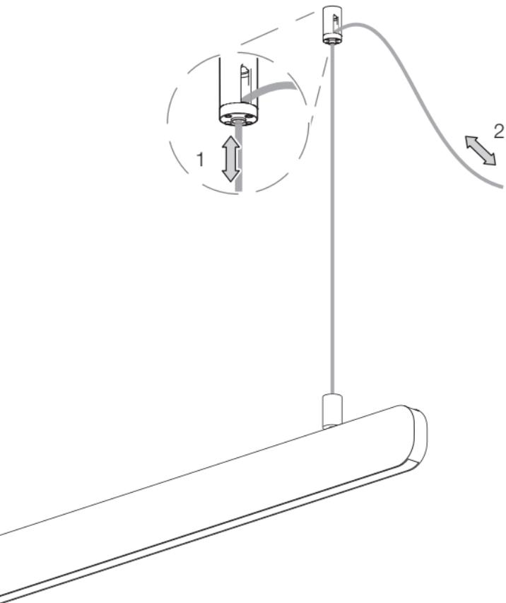
Kabel aufwickeln und Steckverbindung herstellen
