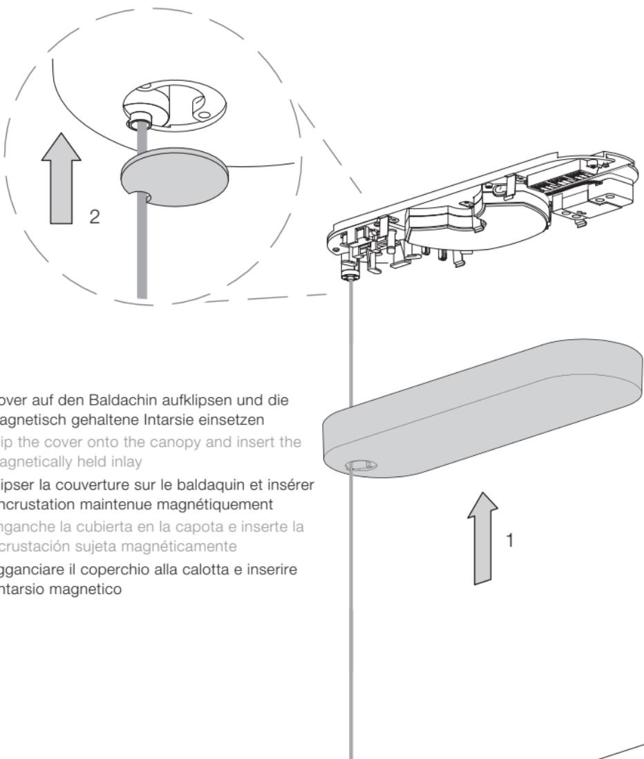
Cover auf den Baldachin aufklipsen und die magnetisch gehaltene Intarsie einsetzen
