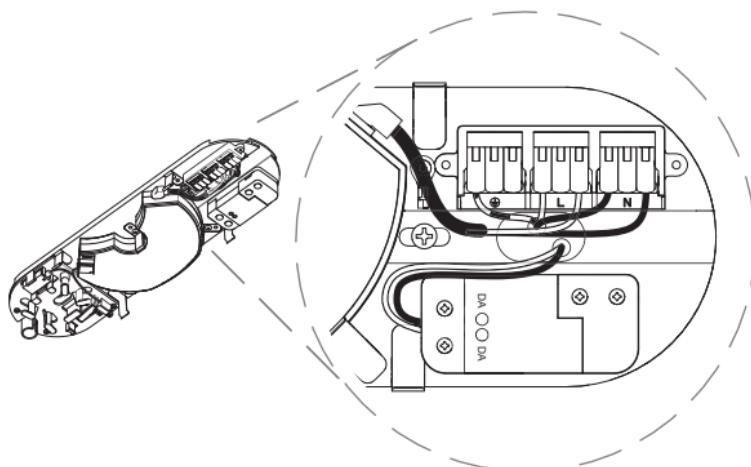
Das Kabel durch die Intarsienöffnung des cover führen
