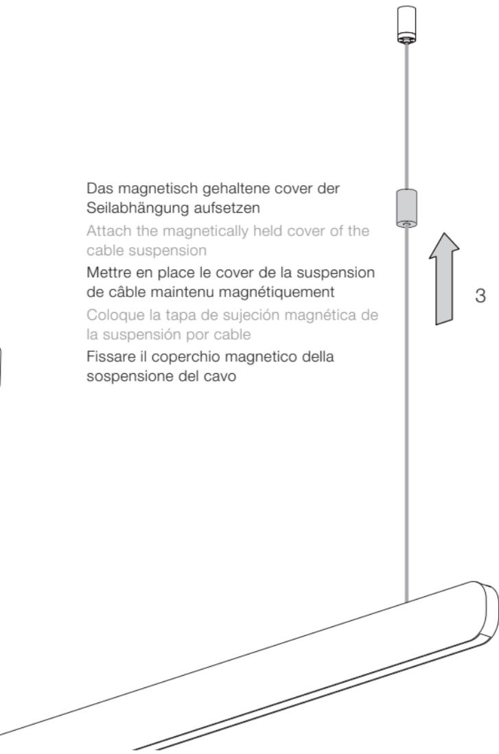
Das magnetisch gehaltene cover der Seilabhängung aufsetzen
