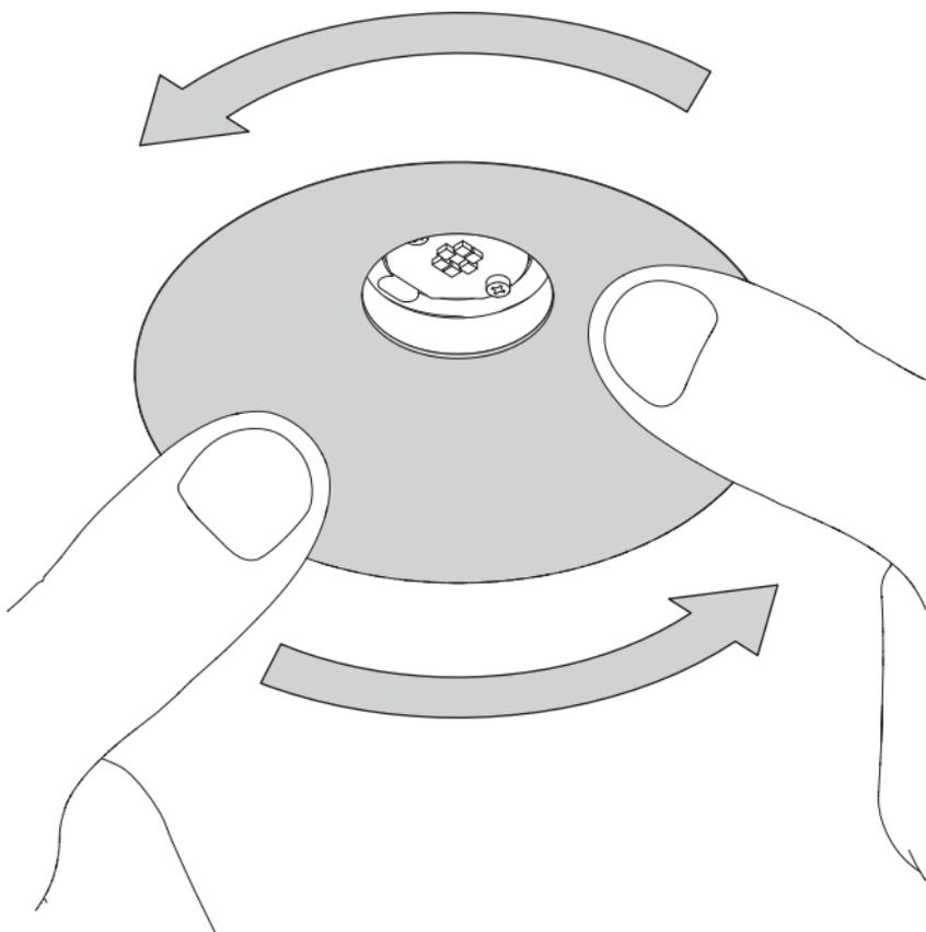
Light unit mit leichten Drehbewegungen nach unten ziehen und entnehmen
