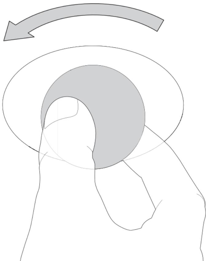
cover gegen den Uhrzeigersinn drehen und nach unten entnehmen
