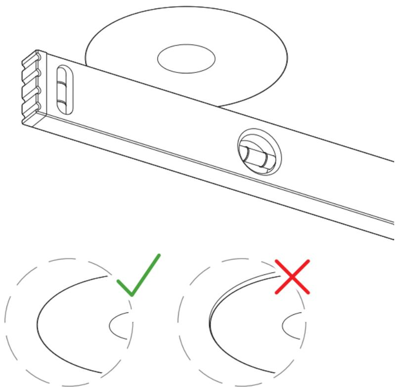
Dünne Schicht Feinputz auftragen, Netzring zum Schutz vor späteren Spannungsrissen auflegen und einputzen
