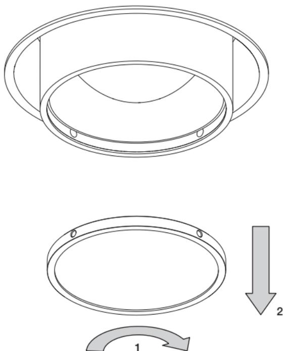
zu **Reinigungszwecken** die inserts nach rechts drehen und nach unten entnehmen
