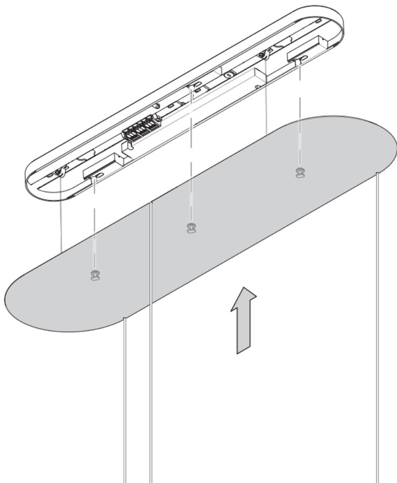
Baldachin einsetzen, bis dieser hörbar einrastet!
