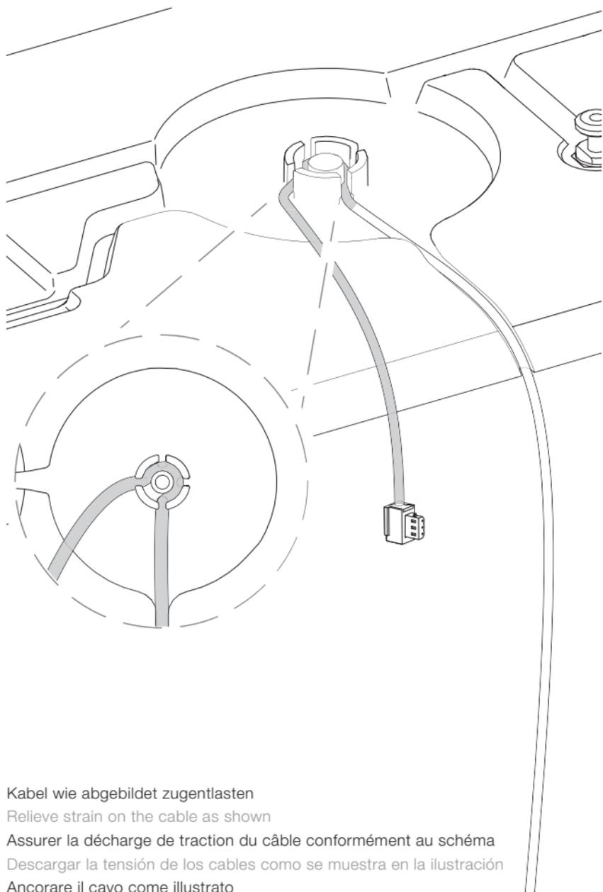
Kabel wie abgebildet zugentlasten
