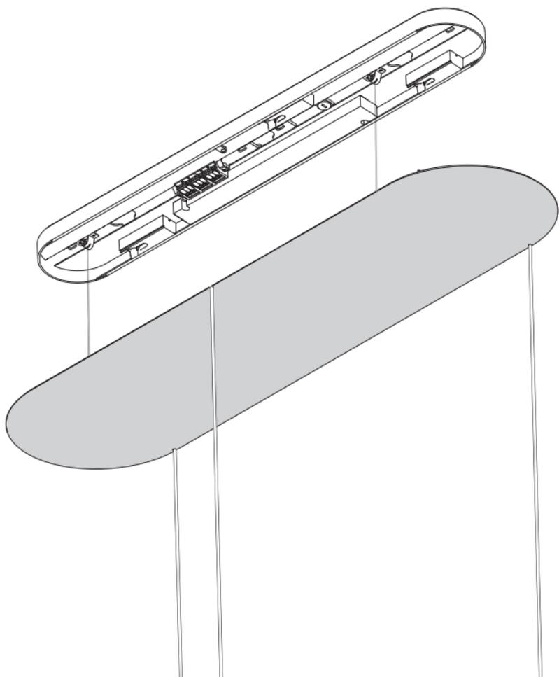
Baldachin eben auf die Montageplatte setzen
