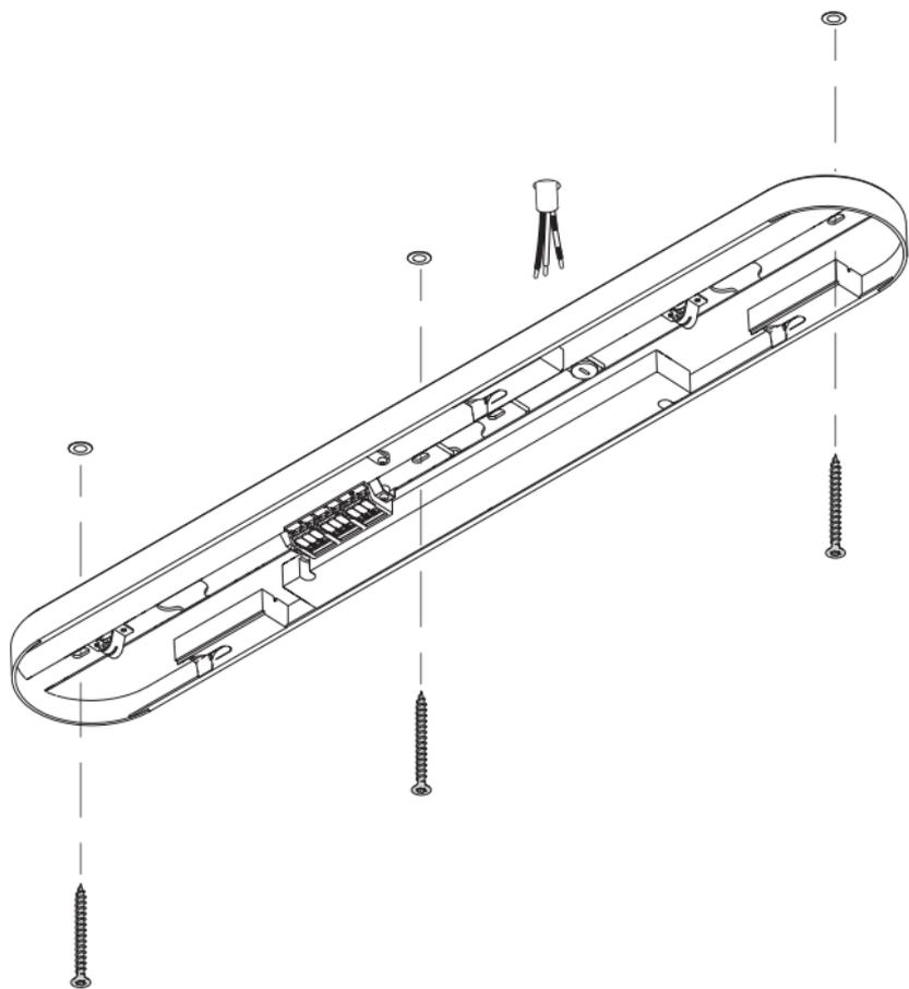
Kabel zugentlasten und wie abgebildet verkabeln
