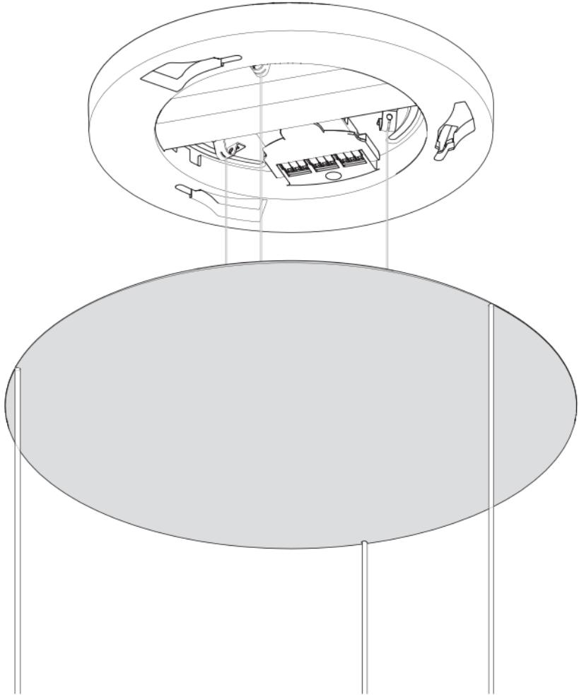
Baldachin eben auf die Montageplatte setzen
