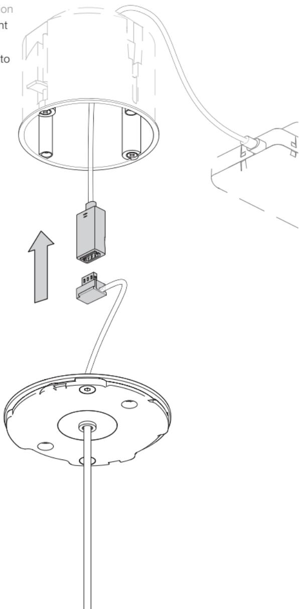
Montageplatte anbringen (Schrauben müssen bündig abschließen)
