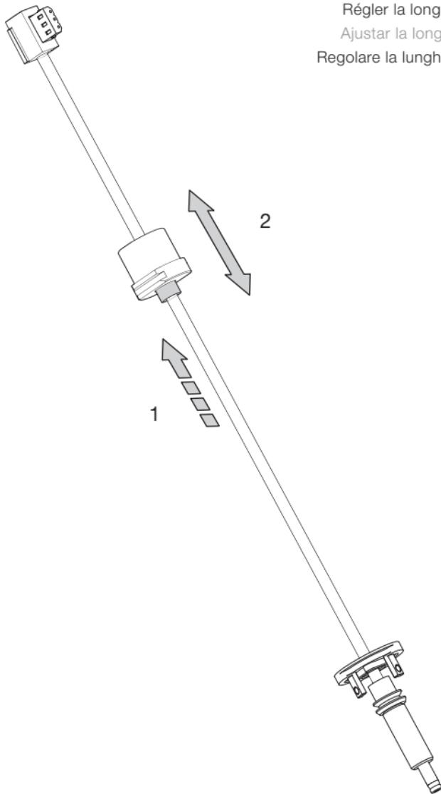
Höhenbefestigung in Deckenbefestigung einsetzen.
