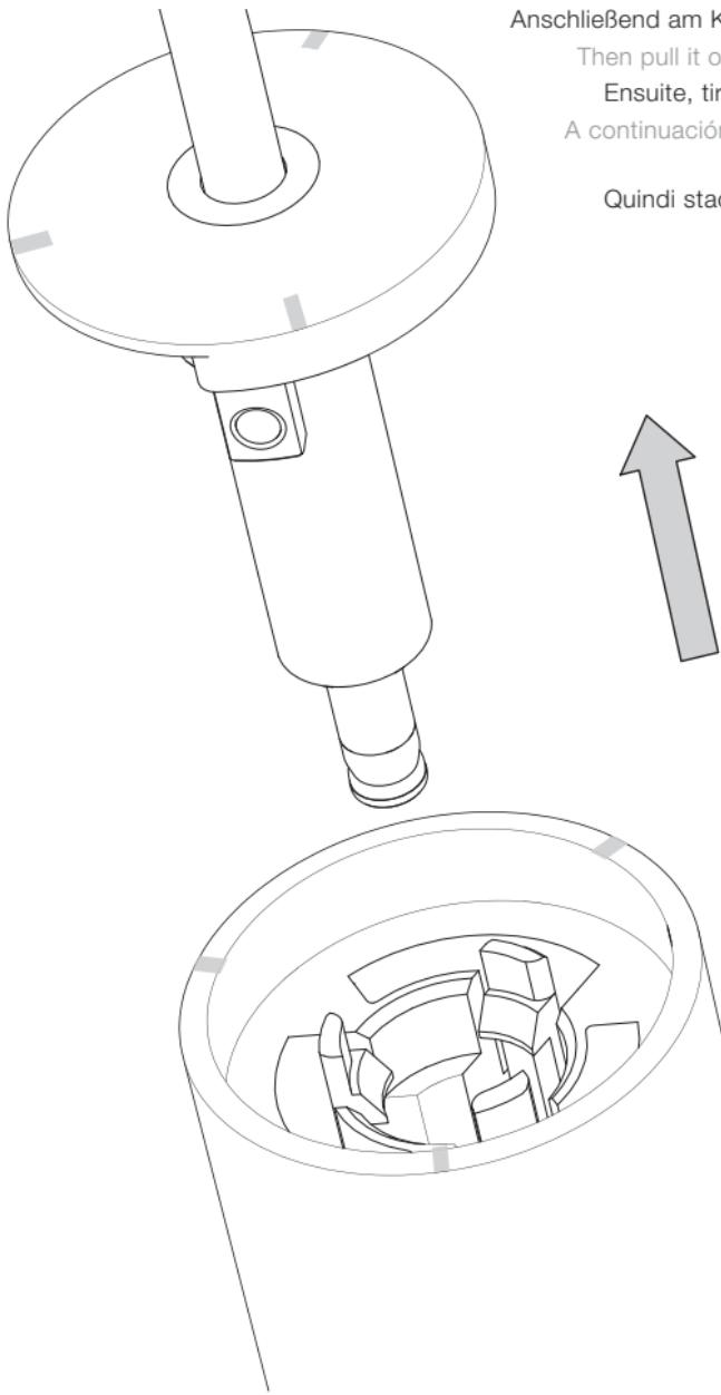
Anschließend am Kabel abziehen.
