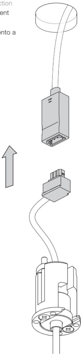
Kabel durchführen und Deckenbefestigung anschrauben.
