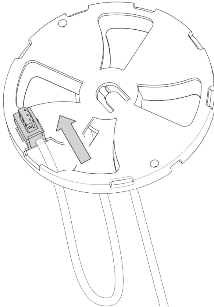
Kabel, wie abgebildet, doppelt aufwickeln (die Kabelaufwicklung kann max.1,5 m Kabel aufnehmen).
