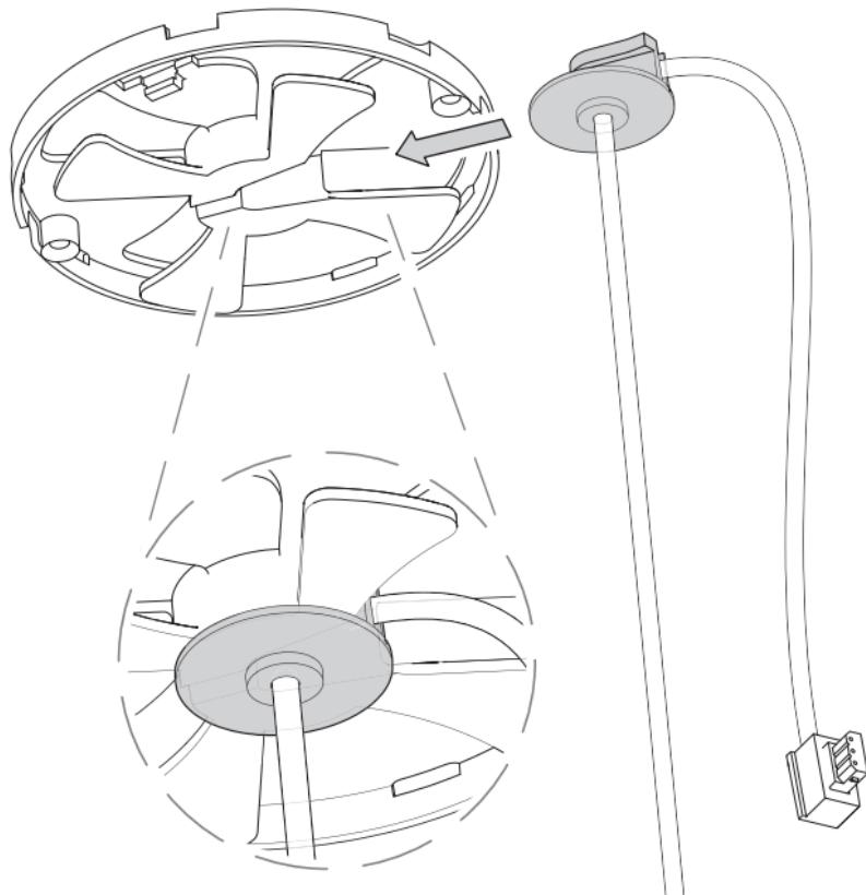
Kabelaufwicklung umdrehen und Stecker wie abgebildet auf der Oberseite befestigen
