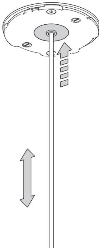
Cover aufsetzen und durch Rechstdrehung arretieren
