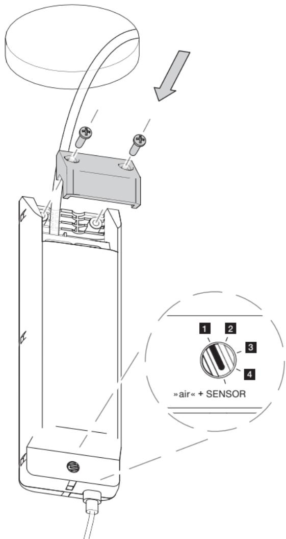
Vorschaltgerät in der Decke verstauen und ggf. die Kante mit einer Feile anphasen für einen deckenbündigen Einbau der Hohlraumdose
