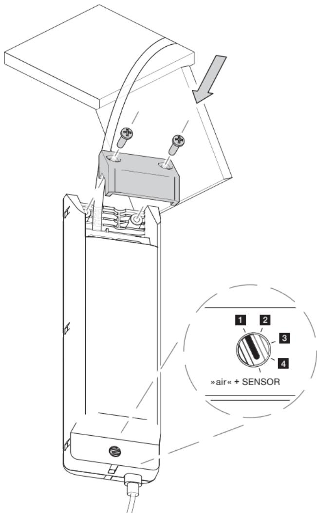
Vorschaltgerät in der Decke verstauen und das Kabel durch die Bohrung führen.
