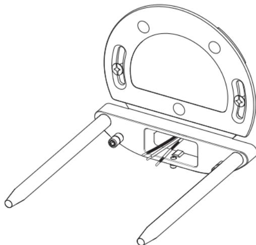
Mounting kit cover leicht lösen und mit Inbusschrauben ausrichten.
