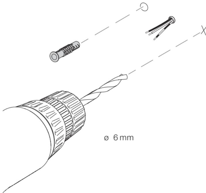
Äußere Kabelisolation wandündig abisolieren, Einzeladern wie abgebildet zur Verkabelung vorbereiten.
