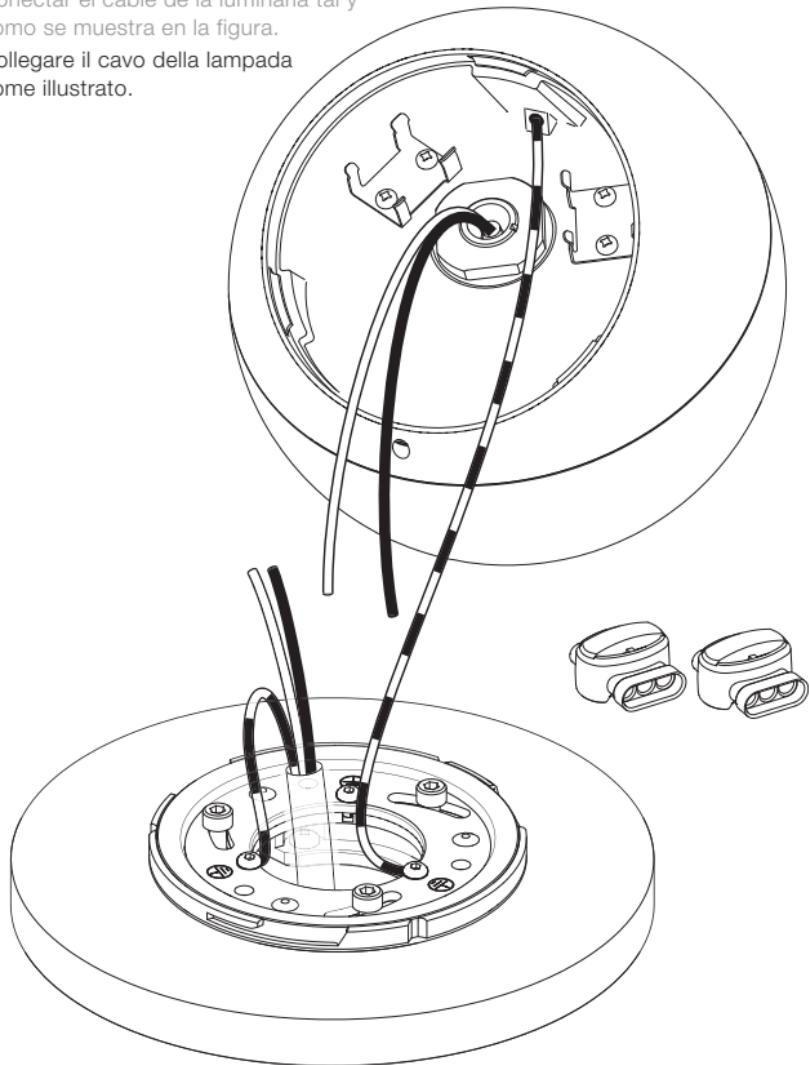
Beide Kabel (max. 1,5 mm<sup>2</sup>) bis zum Anschlag in die Klemme schieben und die blaue Kappe nach unten drücken, die Kabel werden dabei autom. abisoliert.
