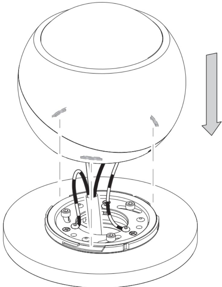
Die Leuchte bis zum Anschlag drehen und mit der Madenschraube fixieren.
