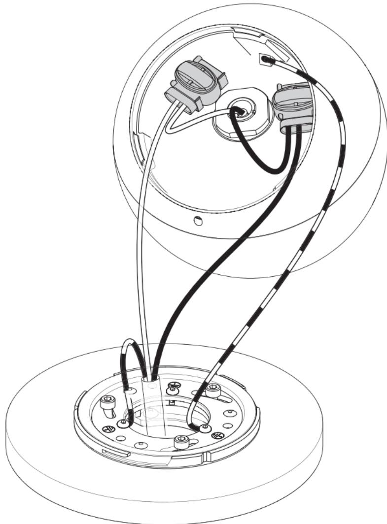
Keine Kabel bei der Befestigung einklemmen!
