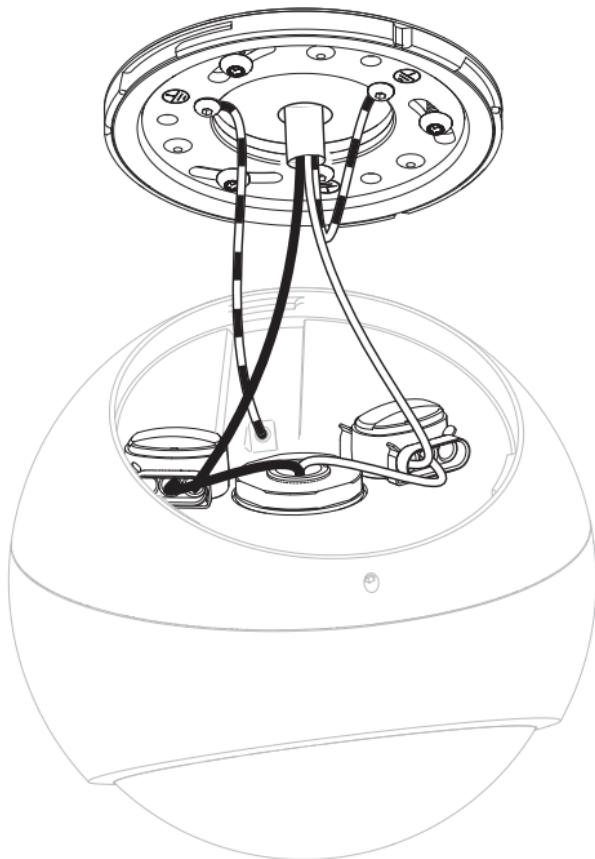
Keine Kabel bei der Befestigung einklemmen!
