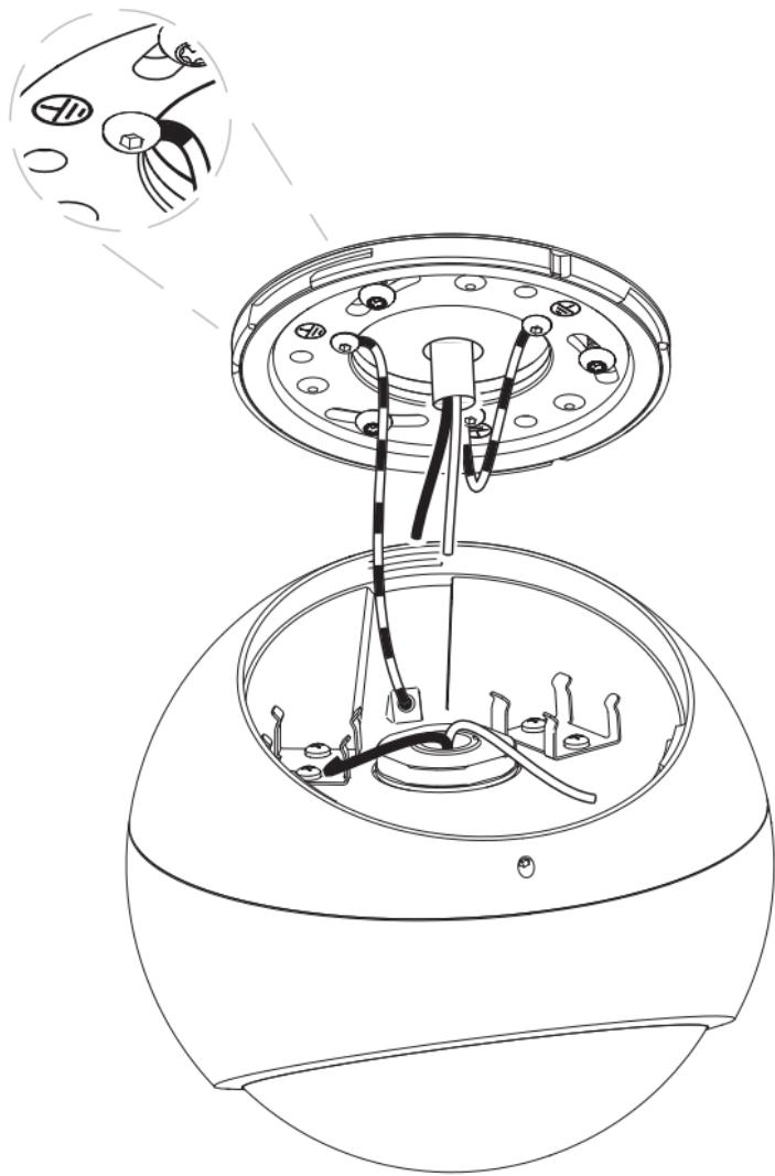
Beide Kabel (max. 1,5 mm<sup>2</sup>) bis zum Anschlag in die Klemme schieben und die blaue Kappe nach unten drücken, die Kabel werden dabei autom. abisoliert.
