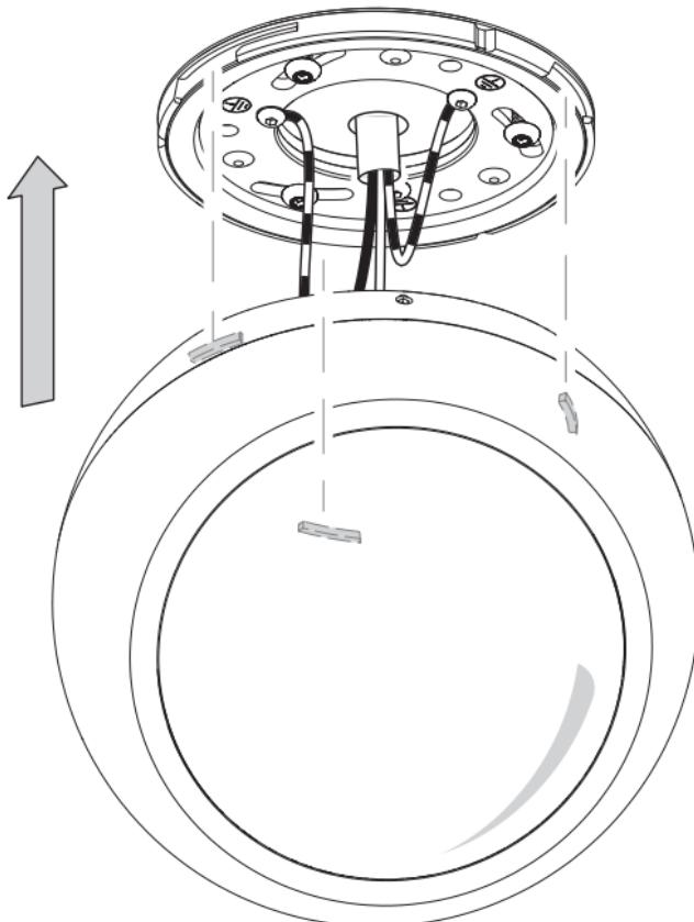
Die Leuchte bis zum Anschlag drehen und mit der Madenschraube fixieren.
