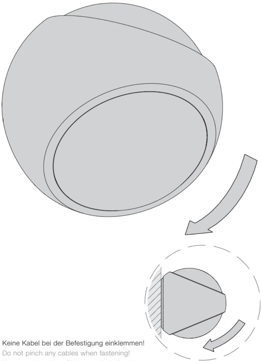
Keine Kabel bei der Befestigung einklemmen!
