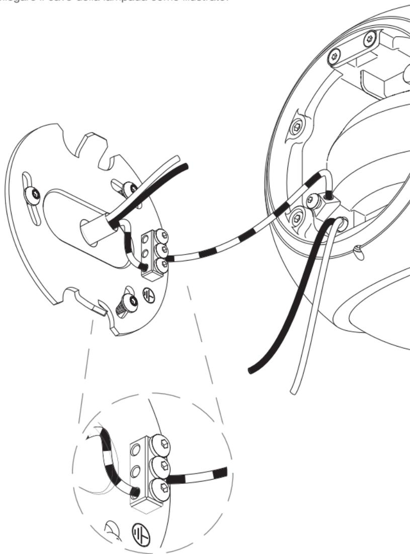
Beide Kabel (max. 1,5 mm<sup>2</sup>) bis zum Anschlag in die Klemme schieben und die blaue Kappe nach unten drücken, die Kabel werden dabei autom. abisoliert.
