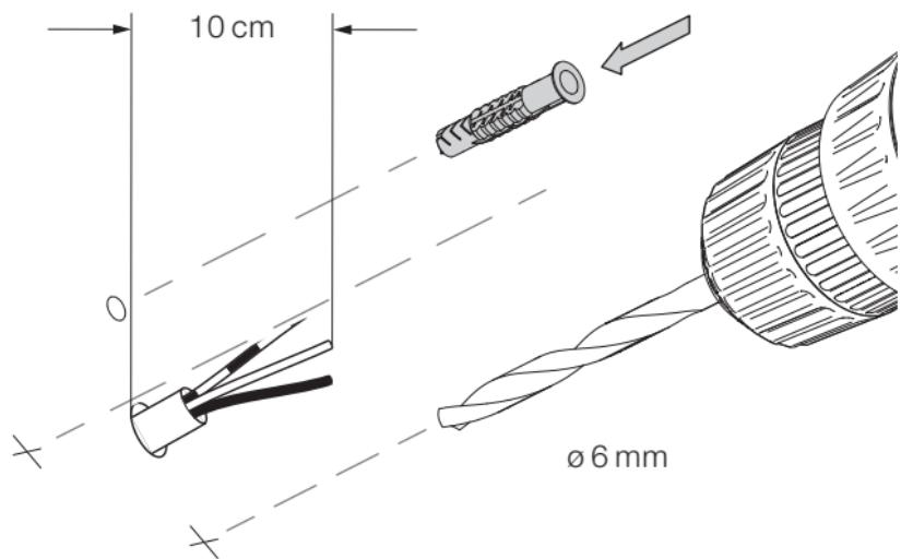
Mit Schrauben befestigen und Kabel der Leuchte wie dargestellt anschließen.
