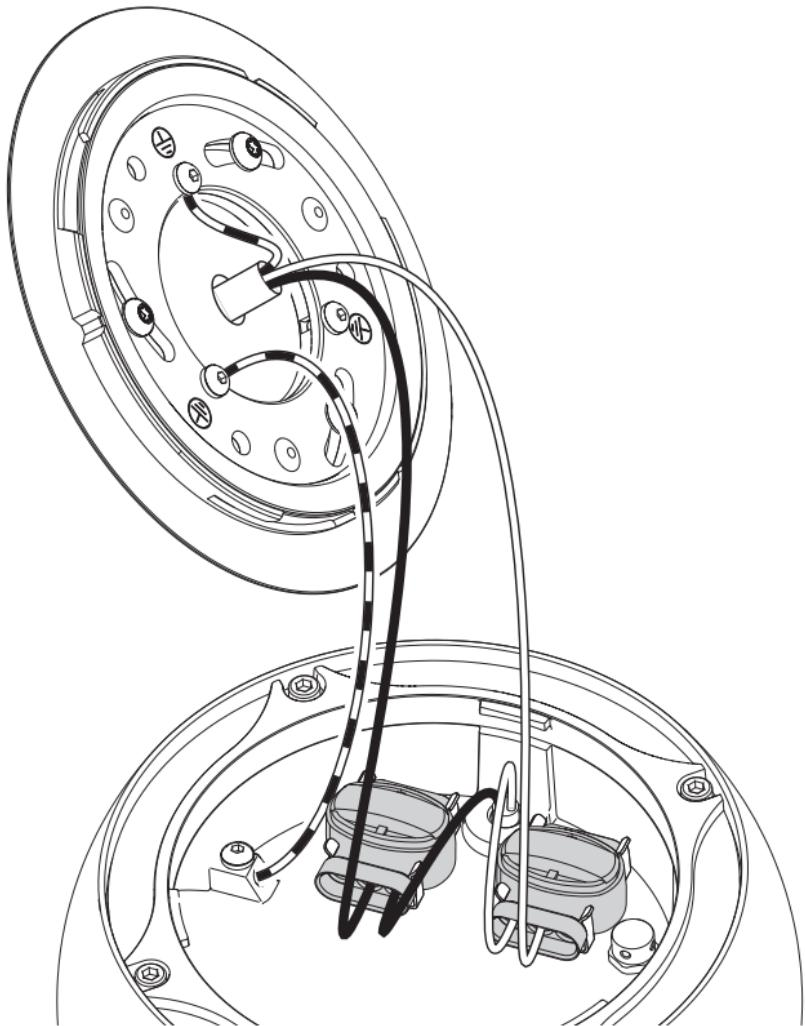
Keine Kabel bei der Befestigung einklemmen!
