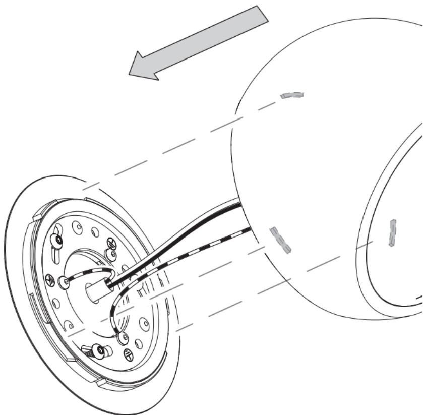
Die Leuchte bis zum Anschlag drehen und mit der Madenschraube fixieren.
