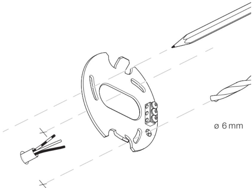
Dübel einsetzen und Montageplatte befestigen.
