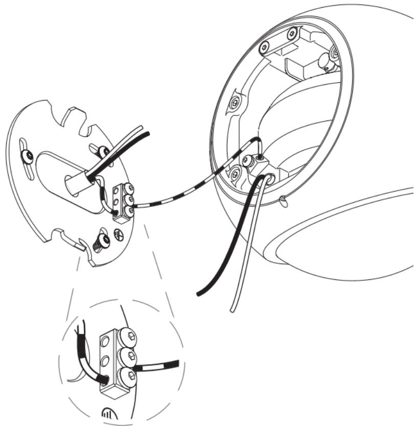
Beide Kabel (max. 1,5 mm<sup>2</sup>) bis zum Anschlag in die Klemme schieben und die blaue Kappe nach unten drücken, die Kabel werden dabei autom. abisoliert.
