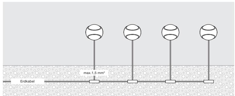
durchverdrahtet mit Verbindungsklemmen
