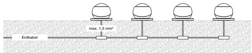
durchverdrahtet mit Verbindungsklemmen
