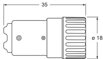
Bei kürzerer Fassung (<28 mm) langer Adapter erforderlich.
