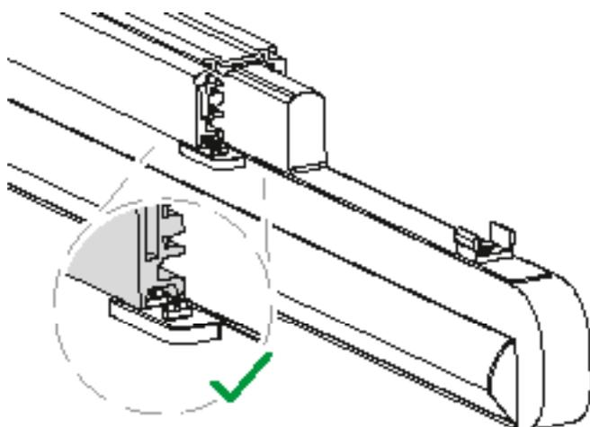
I pin dell'inlay DALI e i contatti del binario DALI determinano l'orientamento della lampada e la direzione dell'emissione luminosa. Pertanto i contatti del binario DALI devono essere orientati verso l'emissione luminosa desiderata.
