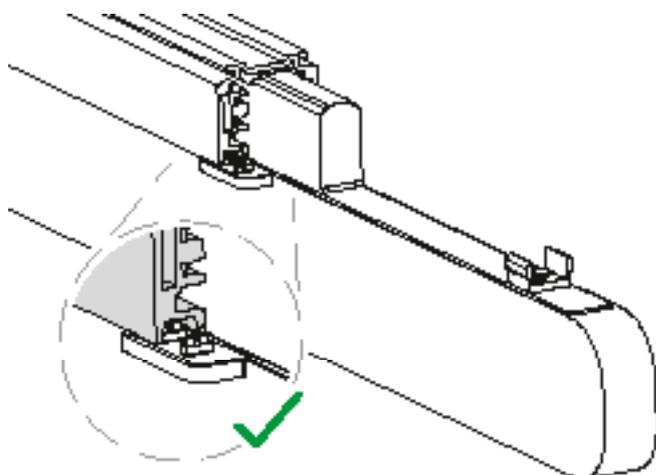
I pin dell'inlay DALI e i contatti del binario DALI determinano l'orientamento della lampada.
