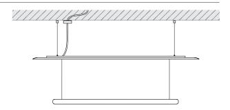
**Trackadapter** für 3-Phasen Erco-, Zumtobel- oder Eutrac-Stromschiene, Anschluss an 230 VAC / 50 Hz Netzspannung (DALI optional nur Eutrac).
