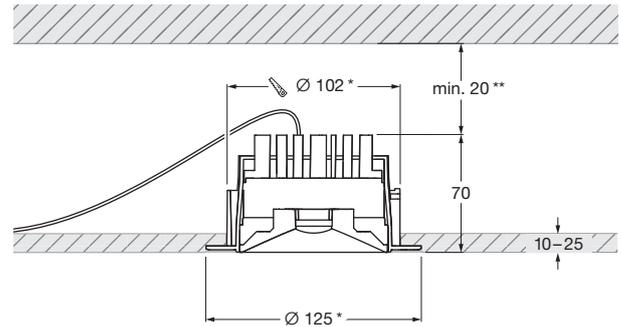
\* Ausschnitt und umlaufende Falz für Montage erforderlich, passender Stufenfräser optional erhältlich
